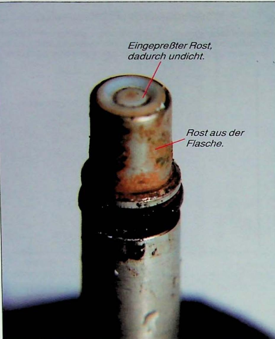
Ein Kolben aus einer kolbengesteuerten 1. Stufe, defekt wegen dem Rost aus einer Flasche.
