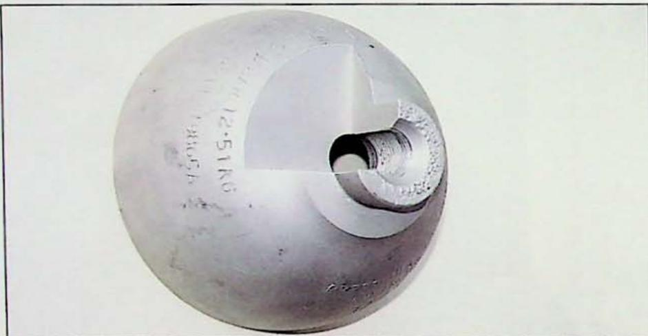
Kopf einer Alufflasche mit bis zu 4mm tiefen Korrosionslöchern an der Kontaktstelle zwischen Alu und Ventil.
