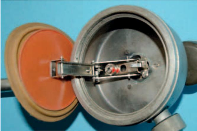
Die Membran ist mit dem Hebelmechanismus fest verbunden.
