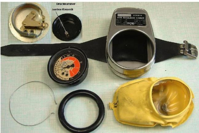
Bild 02: Der DCP und seine Bestandteile
