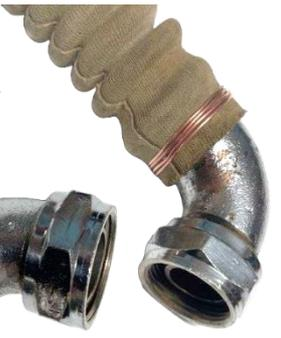
mentation zu diesen seltenen Reglern gesehen habe. Insbesondere werden die Schläuche an den 90°-Bögen mit Kupferdraht festgezogen, der um die Schlauchenden gewickelt und mit einer Zange verdrillt wird.
