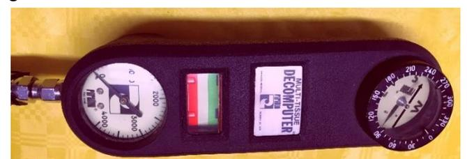
Bild 03: Farallon-Konsole mit Fini und Kompass
