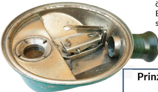
Das Gegendruckventil des Delphin II befindet sich unter dem linken Ende des unteren Kipphebels. Rechts daneben ist die eine Achse des Hebelsystems und ganz rechts unter dem unteren Kipphebel die Feder. Der obere Kipphebel ist ganz rechts angelenkt und drückt somit recht dicht auf den unteren Kipphebel.
