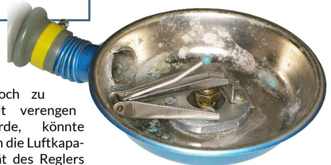
Der obere Kipphebel der PA61 ist ganz links befestigt. Direkt daneben drückt der obere Kipphebel auf den unteren, der am rechten Ende eingespannt ist, wo er auf das Luft spendende Ventil drückt.
