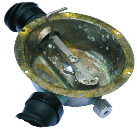
Bei Orliks Automat ist das Ventil in der Mitte unter dem unteren Kipphebel. Am linken Ende des Arms befindet sich der obere Kipphebel. Der Block am rechten Ende des unteren Kipphebels enthält das Gelenk, die Feder und den Ausgleichskolben.
