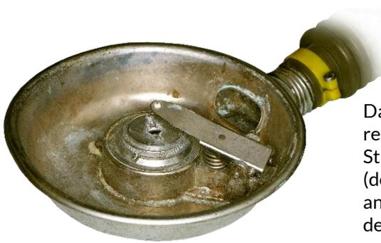
Das Durchflussventil der 2. Stufe des zweistufigen Reglers PA61/II befindet sich unter dem rechten Ende des Kipphebels. In der Nähe davon befindet sich die Achse. Die Feder ist unter dem Kipphebel. Die 1. Stufe befindet sich in der Mitte des Spenders unter dem Kipphebel.
