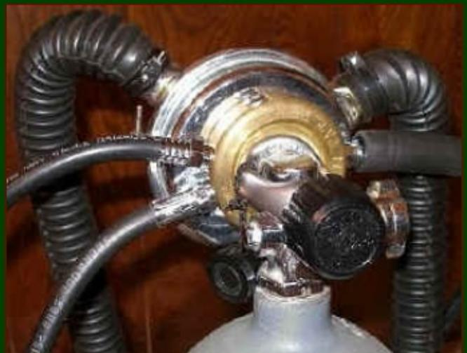
Das Gerät ist als Bausatz konzipiert. Der Käufer ist daher für die Beschaffung der benötigten Teile und die Montage verantwortlich. Soweit ich das verstanden habe, enthält jedes Set das Hauptgehäuse, ein Flaschenjoch und den Druckknopf der ersten Stufe. Je nachdem, ob sich eine Bezugsquelle findet, liefert er möglicherweise alle Teile der ersten Stufe.
